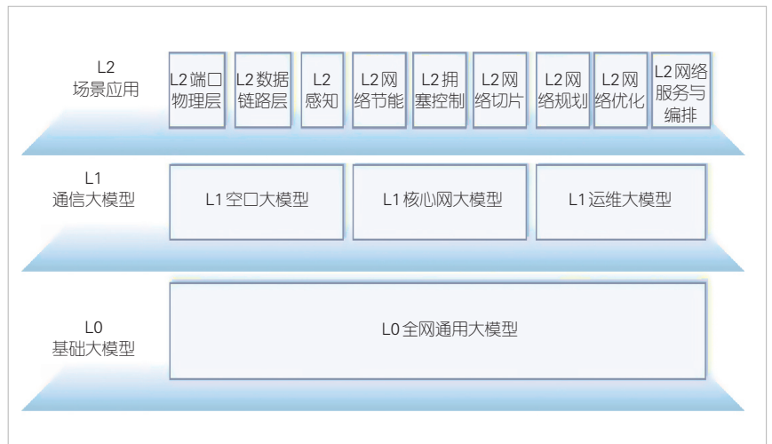
▲图5 网络大模型NetGPT的3层架构 [34]
